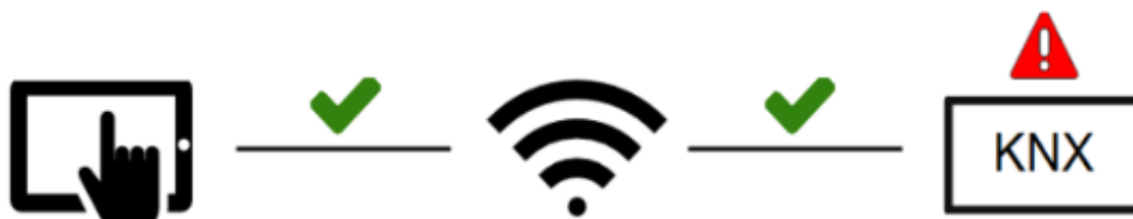
Abbildung 6 – KNX-IP-Interface meldet einen Fehler
